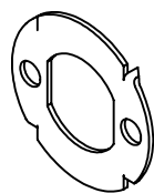
A1012 Rondella con punte per fissaggio legno Locking Washer for Wood Fixing
