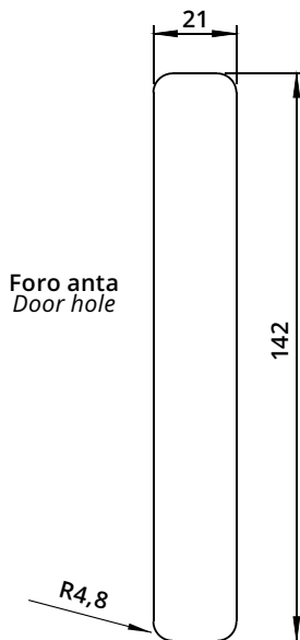
Montaggio su anta in legno Assembly on Wooden Door
